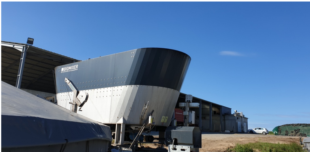
PHOTO 2 : trémie d'incorporation des matières solides (GAEC DES PINS®)
